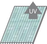
**2** La plancha debe ser instalada de manera que los alveolos corran paralelos a la pendiente.
