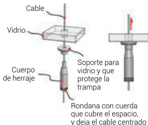
El soporte intermedio sirve para sostener cada entreaño de vidrio, su trampa regula hacia arriba y abajo para colocar cada pieza a la altura requerida.
