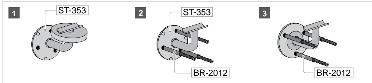
El soporte está diseñado para posibilitar su fijación en un solo tiempo usando tacos premontados. Una vez finalizado el montaje y asegurado el soporte sobre la superficie de apoyo, se fija el embellecedor ejerciendo una pequeña presión sobre la base, quedando la goma oculta en su interior. [img.1]
