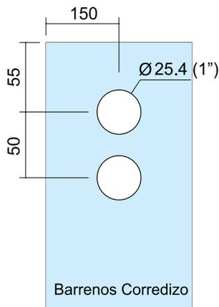
La altura de los barrenos que corresponde a los conectores a vidrio para fijos, se calcula de la siguiente manera:
