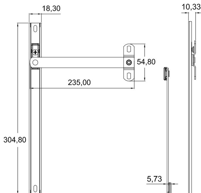
\*Se instala como brazo compensador al colocar un operador de brazo largo, para ayudar al funcionamiento de la ventana de proyección.
