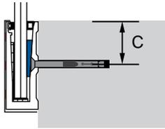
Hormigón comprimido: C = 60mm
