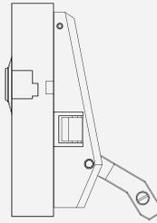
Cilindro instalado por el exterior
