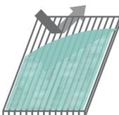
**8** Una lámina puede ser curvada perfectamente en frío con dirección longitudinal. Los radios de curvatura varían entre 750 y 1500mm según el espesor de la plancha. No se deben instalar los alveolos en forma perpendicular a la pendiente, la estructura alveolar no está diseñada para trabajar en sentido inverso.
