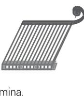
**6** Protege los bordes inicial y final de la plancha con perfiles de policarbonato tipo "U".
