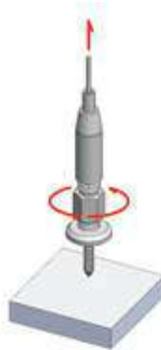
Base inferior con ajuste para tensar el cable de acero. Este herraje se compone de varias partes para fijar la base al piso, considere un tornillo ó pija con el tamaño adecuado de cabeza, ya que la tuerca debe entrar en la base y adentro de ambos el tornillo, como se muestra en la imagen.
