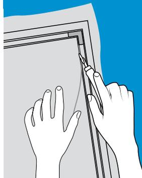
Auxiliar en el reemplazo de mosquiteros de aluminio ó fibra de vidrio, que emplean marcos hechos a base de perfiles con canal para empaque plástico (spline).
