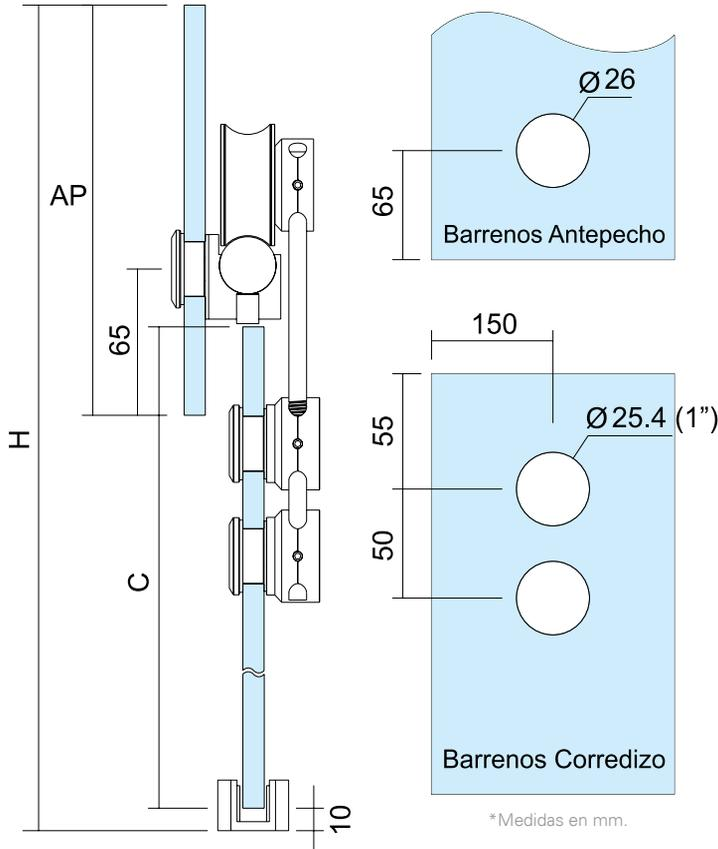
La altura de los barrenos que corresponde a los conectores a vidrio para fijos, se calcula de la siguiente manera:
