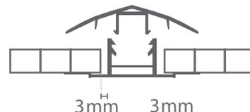
**4** El distanciamiento de los tornillos para la fijación de los perfiles a la vigas, no deberá ser mayor a 40cm.
